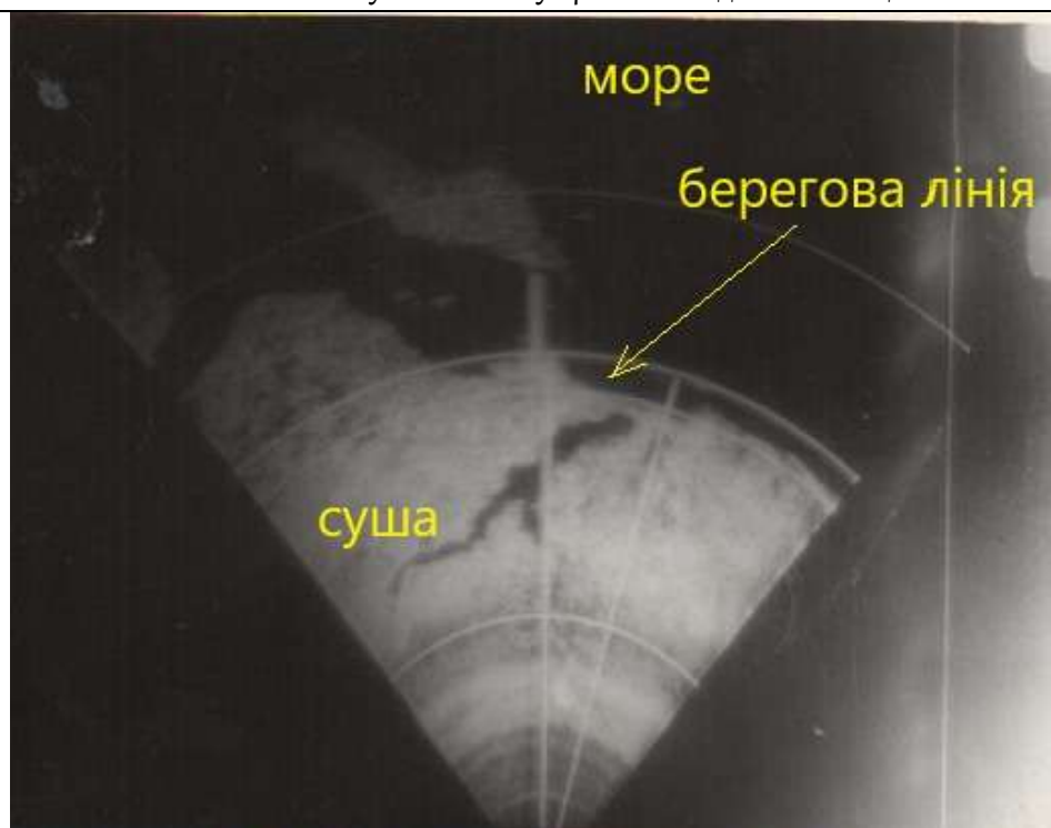
Рисунок 1 – Фото екрану радіолокатора переднього огляду (в напрямку моря)
