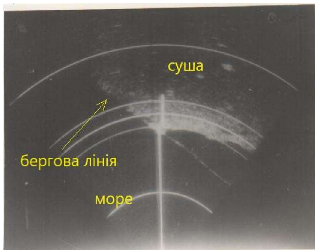
Рисунок 2 – Фото екрану радіолокатора переднього огляду (в напрямку суші).
